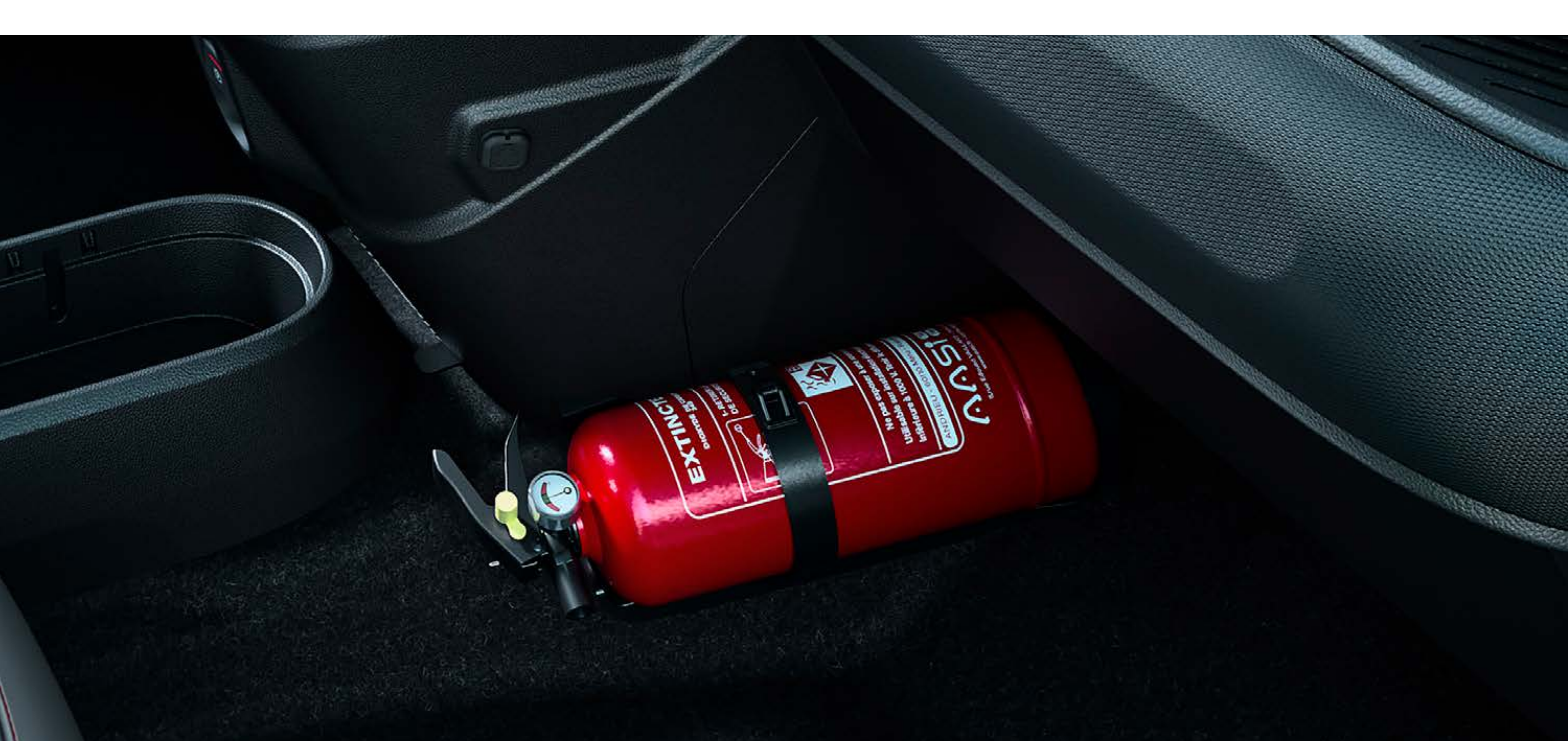
fixation pour extincteur et extincteur de 1 kg
