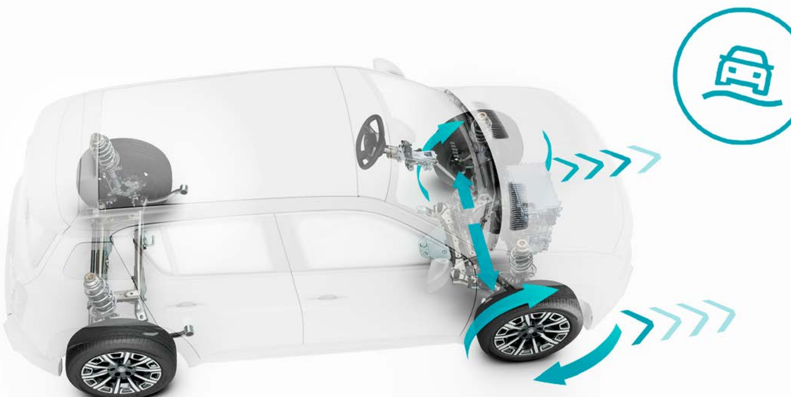
opis diagrama: sistem proti spodrsavanju pogonskih koles s funkcijo Extended Grip (1)
