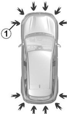
Ultrazvočni senzorji, označeni s puščicami **1**, so nameščeni v odbijačih, da zaznavajo ovire v bližini vozila.
