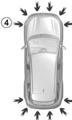
Z uporabo podatkov iz kamer **1**, **2** in **3**, ki so nameščene v sprednjem odbijaču, zunanjih ogledalih in na prtičnih vratih, ter iz ultrazvočnih senzorjev **4**, ki so nameščeni na odbijačih vozila, funkcija nudi pomoč pri težjem manevriranju (npr. pri parkiranju) tako, da prikaže okolico vozila.
